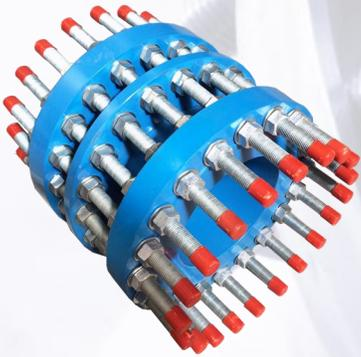
Las Uniones de Desmontaje Autoportante son elementos necesarios en el diseño y disposición de las válvulas en las tuberías, ya que son de gran ayuda durante los procesos de instalación y eliminación de secciones de tubería y válvulas. Sin este tipo de uniones que permiten un ajuste longitudinal, es casi imposible acomodar de forma correcta y segura una válvula en una sección de tubería.
